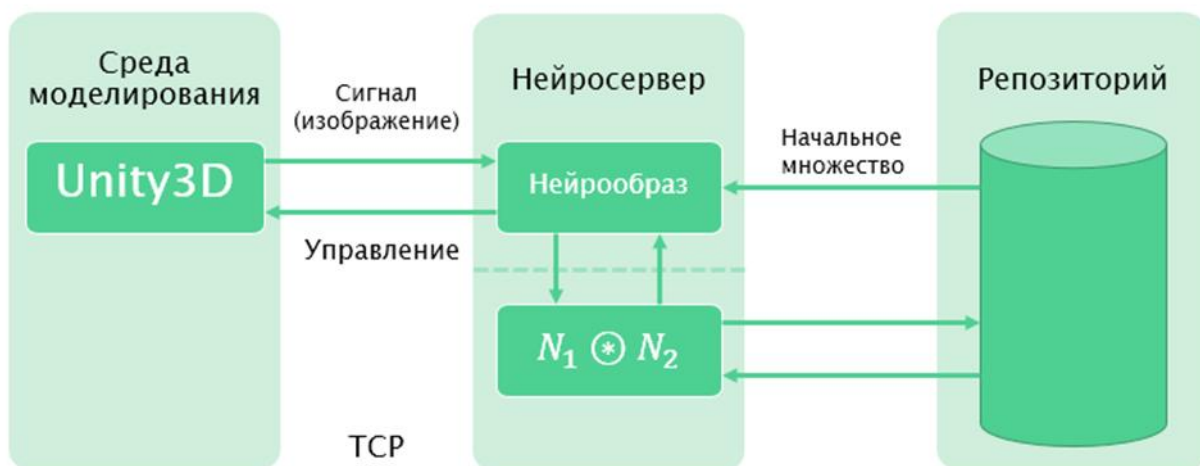
Рисунок 3 - Архитектура системы нейроэволюции
